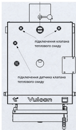
Рис.10 Підключення системи термічного розвантаження
